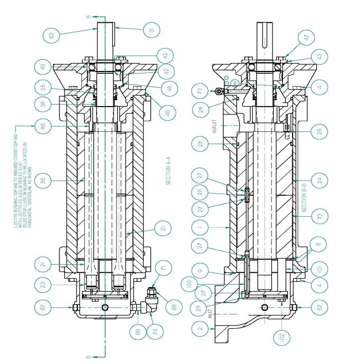
FIG 8 - G6D-275 C-FACE PUMP ASSEMBLY
